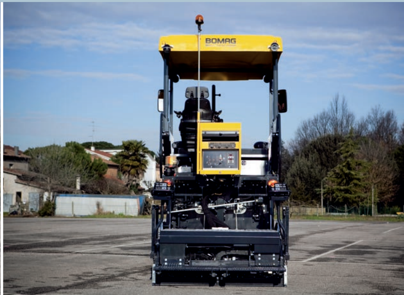
Минимальная ширина платформы с базовой стяжкой – 1,70 м
