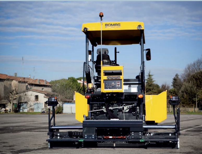
Максимальная ширина платформы с базовой стяжкой – 3,40 м
