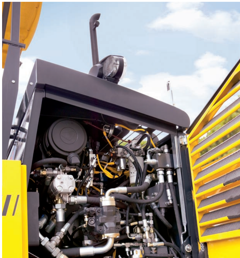
...легкий доступ ко всем составляющим гидравлической системы и двигателя.
