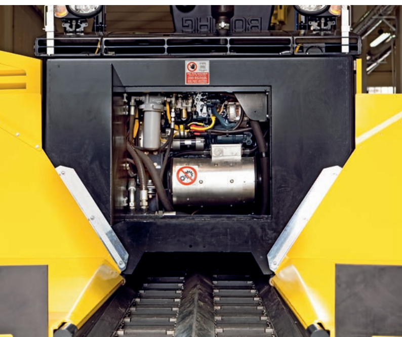
Трехфазный генератор переменного тока на 13 кВт сокращает время нагревания.
