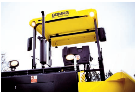
Освещение: согласно стандартным требованиям асфальтоукладчик оснащен мощными фонарями со всех сторон.
