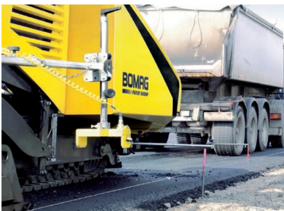
Многофункциональность: интерфейс системы выравнивания находится в соответствии со всеми стандартными системами и датчиками.
