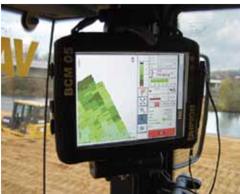
BCM 05 – непрерывное документирование уплотнения, как на географической карте
