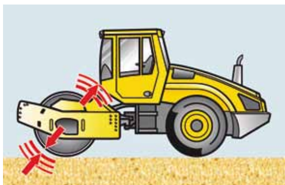
Положение угла = согласованная энергия уплотнения
