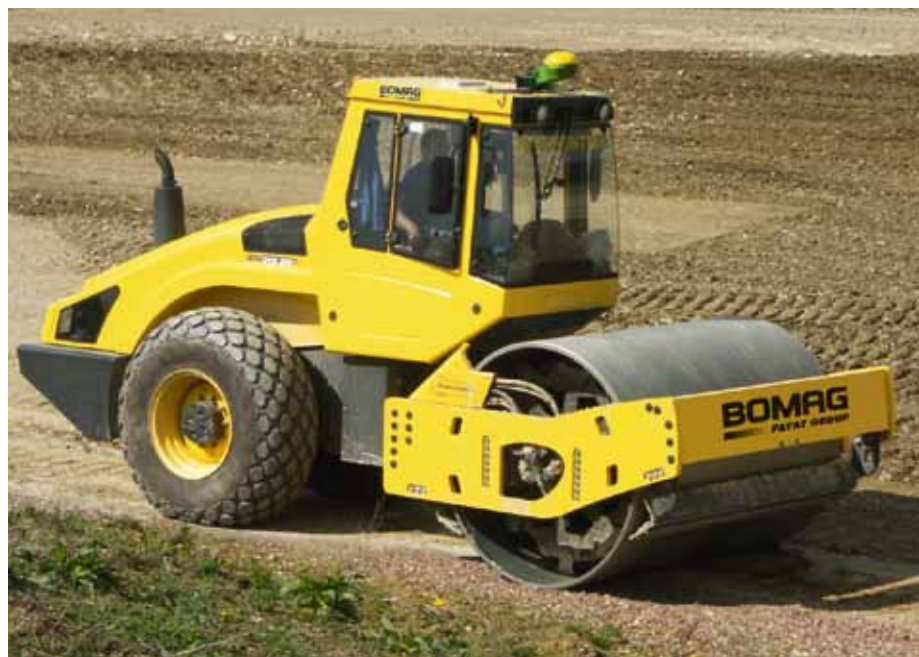
BCM 05 – непрерывное документирование уплотнения, как на географической карте
