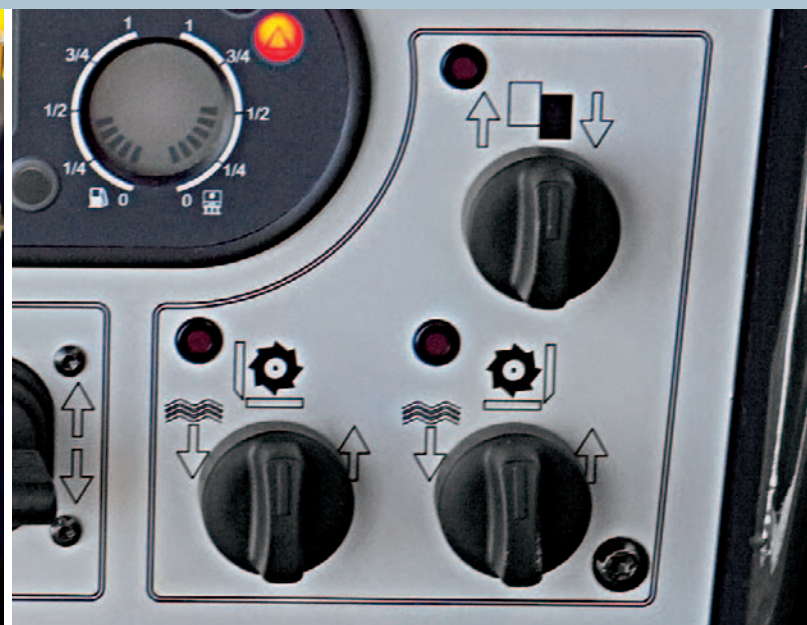
Управление составной задней стенкой может быть также осуществлено с панели оператора.
