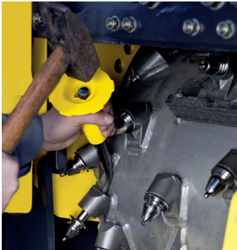
Максимально удобное обслуживание, простой и быстрый процесс смены резцов экономят время и деньги.
