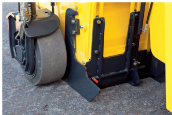
Выдерживающие нагрузку полозья из твердого сплава.
