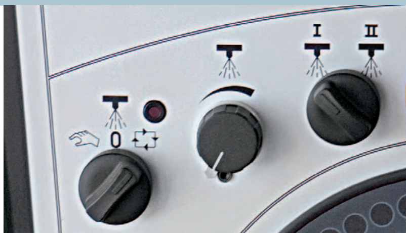
Простое регулирование распыления воды с помощью двух управляющих тумблеров.
