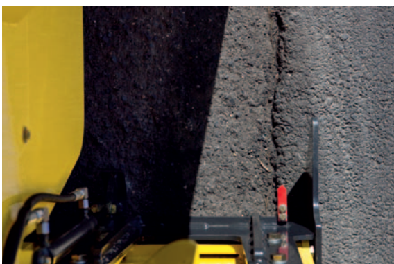
Расположенный на прижиме указатель края фрезерования обеспечивает точный подвод.
