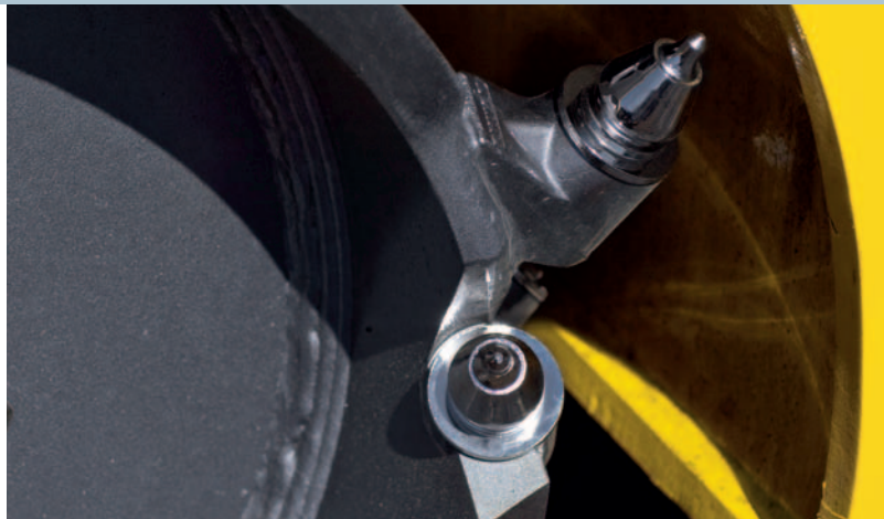
Особая геометрия краевых резцов создает ровную кромку среза. Боковые резцы защищают барабан при движениях на поворотах.
