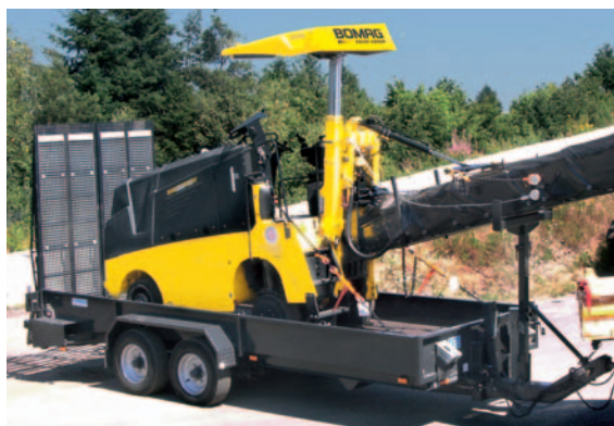
При транспортировке погрузка дорожной фрезы осуществляется задним ходом ...
