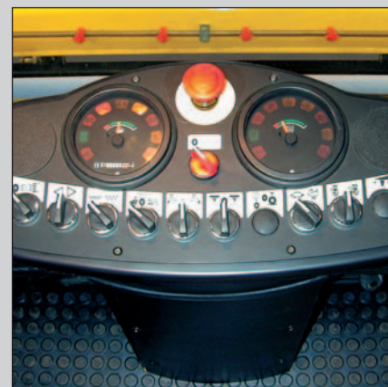
Безопасность: аварийный выключатель и сигнальные лампы расположены в центре консоли.
