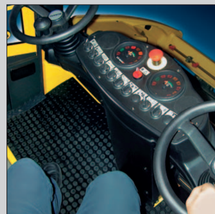
Кресло оператора с двумя рулевыми колесами: хороший обзор, понятная символика
