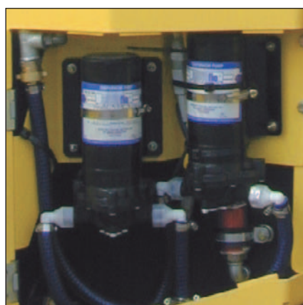
Система орошения с двумя насосами: удобное управление, не отходя от операторского кресла
