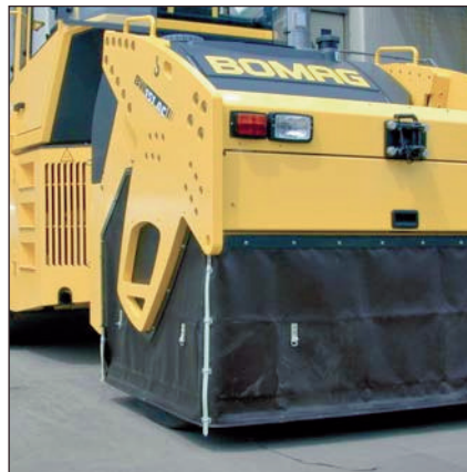
Термочехол: для более длительного сохранения тепла бандажей комбинированного катка.
