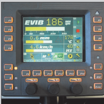
Центральный дисплей для катков с системой Asphalt Manager
