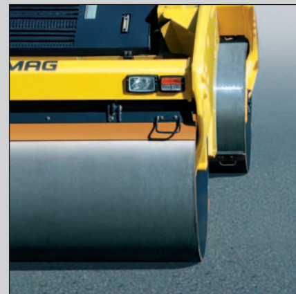
Боковое смещение задней полурамы (170 мм), серийное производство
