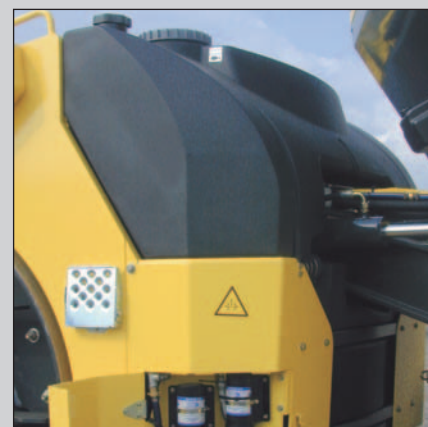
Большие емкости для воды экономят время благодаря их нечастому наполнению
