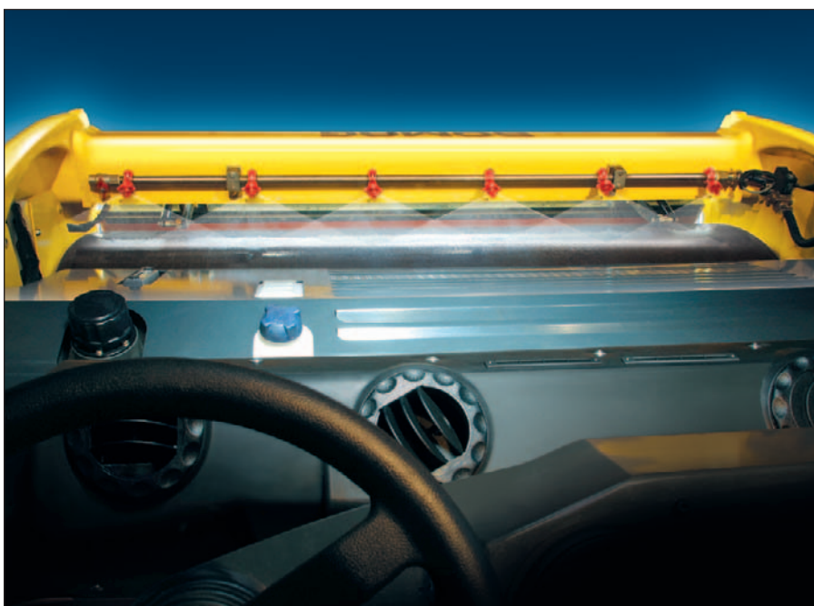
Оптимальное распределение воды с помощью 6 распылителей; надежная система с 3-х ступенчатой системой фильтрации.
