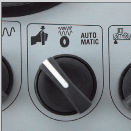
Выбор способа включения вибрации: вручную или автоматически
