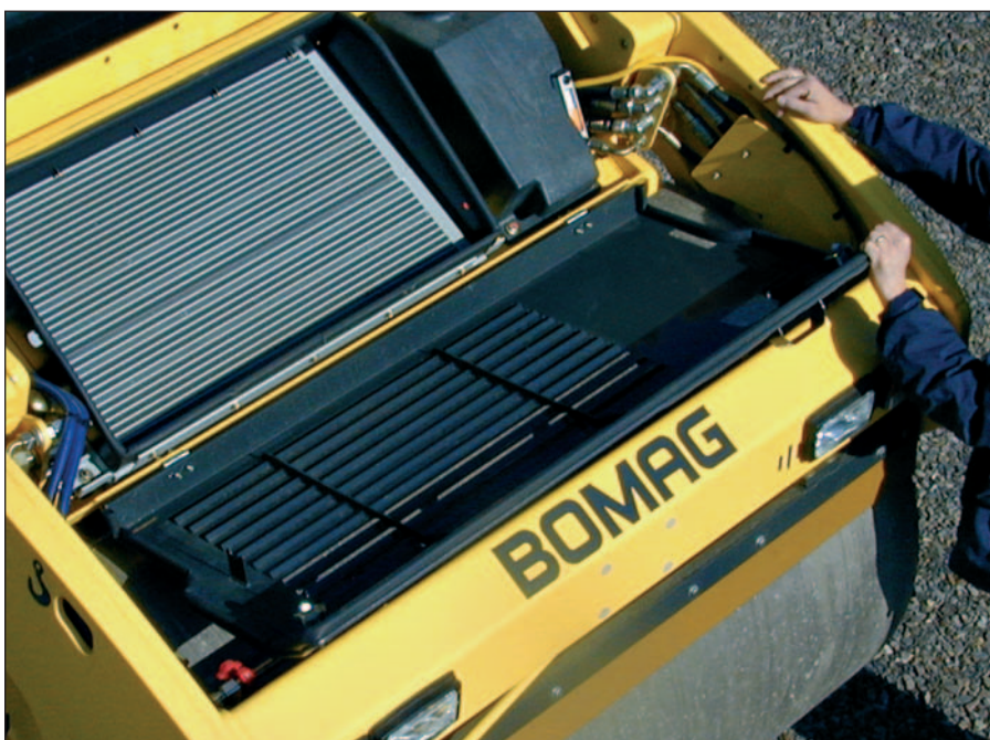
Все компоненты легко доступны для обслуживания: очистка радиатора
