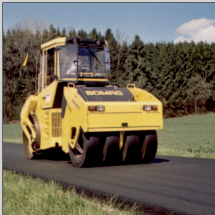
Комбинированные катки для качественного уплотнения поверхности.
