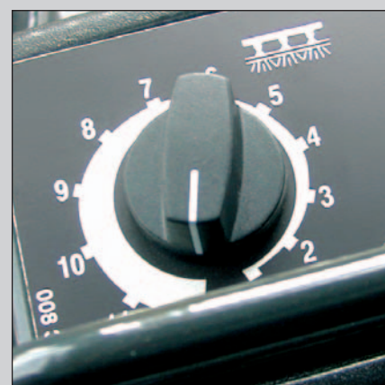
Экономное потребление благодаря 12-ти ступенчатому выключателю прерывистого режима работы.
