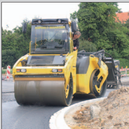
BW 154 AD с секционными бандажами; без проблем на поворотах.
