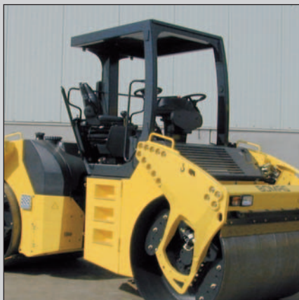
Безопасность: кресло оператора с поручнями, с системами безопасности ROPS (защита при опрокидывании) и FOPS (защита от падающих предметов).
