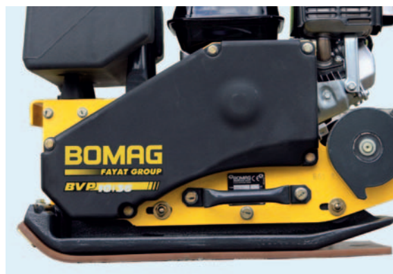
Коврик из синтетического материала (опция): для мостовых работ.
